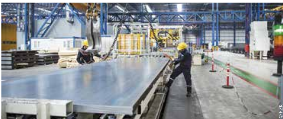
Compania poate prelucra tablă cu grosime de până la 1000 mm și lățime de până la 4000 mm, ideală pentru satisfacerea necesităților firmelor locale de construcții navale și furnizoare de țigări și gaze naturale.
