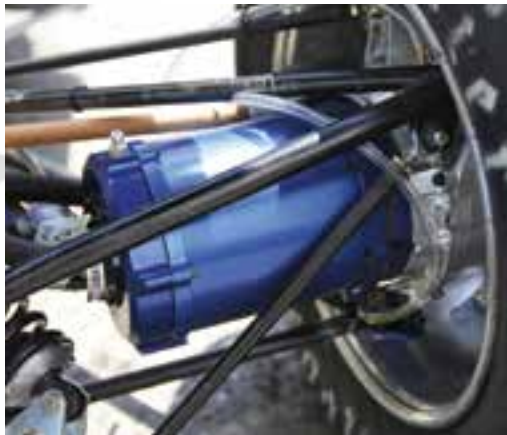
Fiecare roată este acționată de un motor electric independent realizat cu iCARE® Save
