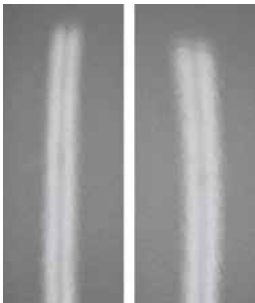
Această imagine prezintă două panouri. Moștra din stânga beneficiază de acoperire Ultragal®. Remarcați reflexia luminii fluorescente. Ondulația de pe panoul din dreapta (tratată cu Extragal®) este subliniată de reflexia distorsionată.
